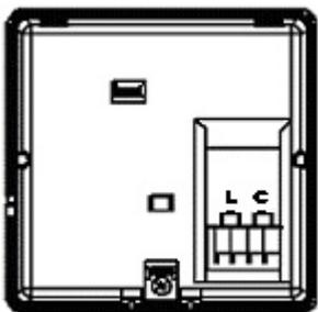
Déconnectez la tension d'alimentation de la boucle de détection avant d'installer le bouton.
